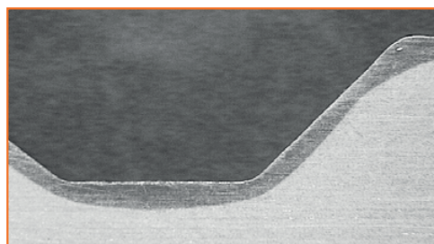
Ett typiskt härdsnitt av en formande verktygsdel, 1,2mm härdjup.
